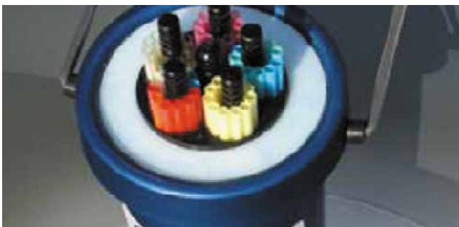
Криокамера FC5AT с криосоломинами 0,5 мл
